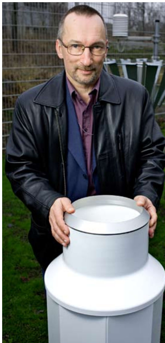
Keijo Leminen esittelee automaattista sateenmittausanturia. Taustalla vanhanmallinen sademittari.
